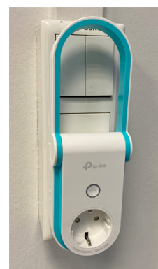
Beispiel für einen Repeater zur Erweiterung des W-Lan Netzes
