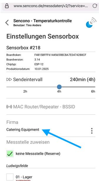
5. Ordnen Sie die Messstelle zu und passen bei Bedarf den Aufzeichnungsintervall an.
